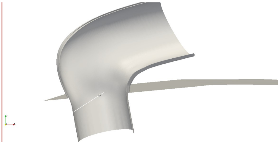
Obr. 5.6: Model výfuku leteckého motoru
